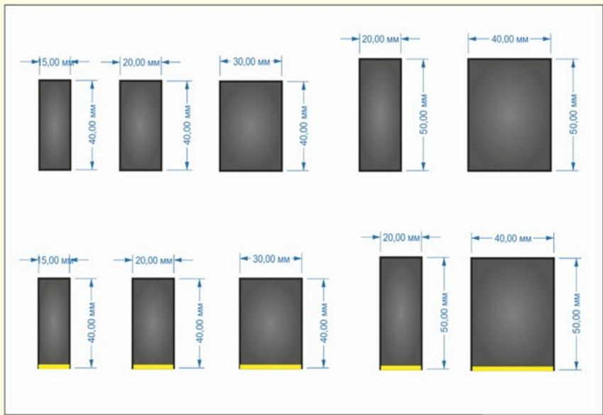
При такой толщине уплотнитель имеет **оптимальные** технические характеристики. Длина уплотнителя стандартно 1000 мм. Ширина уплотнителя так же имеет стандартные размеры 15 мм / 20 мм / 30 мм / 40 мм. Возможно производство по Вашим размерам.
