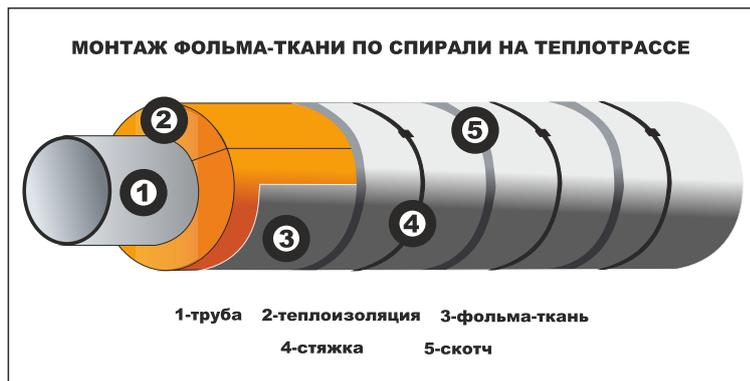
2. **Монтаж по длине трубы** – может применяться, только при диаметре трубы вместе с изоляцией не более 30см. Стык проклеивается скотчем. В качестве стяжки может использоваться – проволока, стальная лента, либо полимерная УФ-стойкая лента со скобами.
